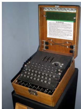
Figura: máquina Enigma G, com 3 rotores.
