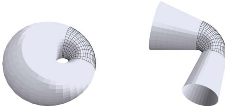
Figura: Usando uma cíclide de Dupin para conectar dois troncos de cone.
