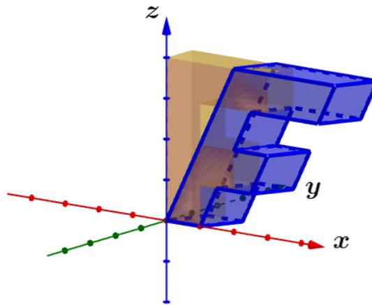
Figura 3.31: Cisalhamento na direção do plano  $xy$
