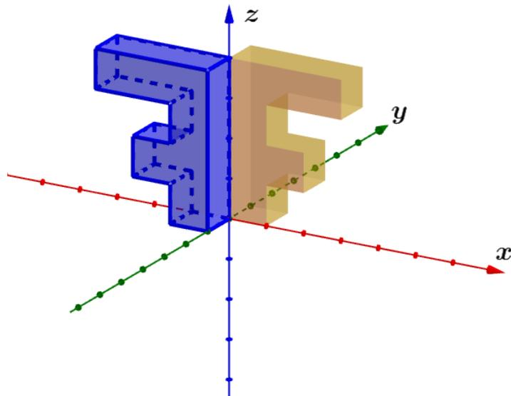
Figura 3.23: Reflexão no eixo dos  $z$  quando  $\alpha = 180^\circ$
