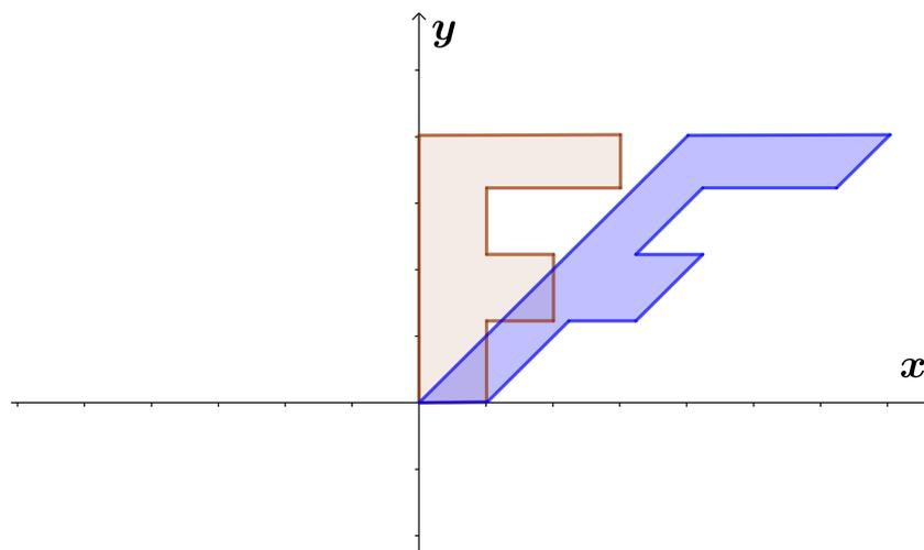
Figura 3.19: Cisalhamento na direção  $x$  de razão  $k = 1$
