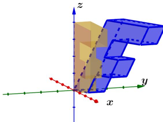
Figura 3.30: Cisalhamento na direção do plano  $yz$
