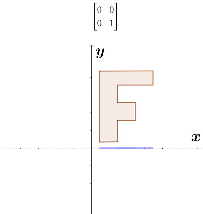
Figura 3.11: Projeção sobre o eixo dos  $x$
