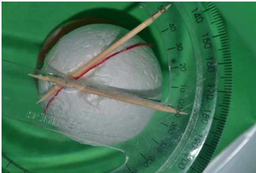
Figura 66: Uso do transferidor para medir ângulos entre circunferências máximas
