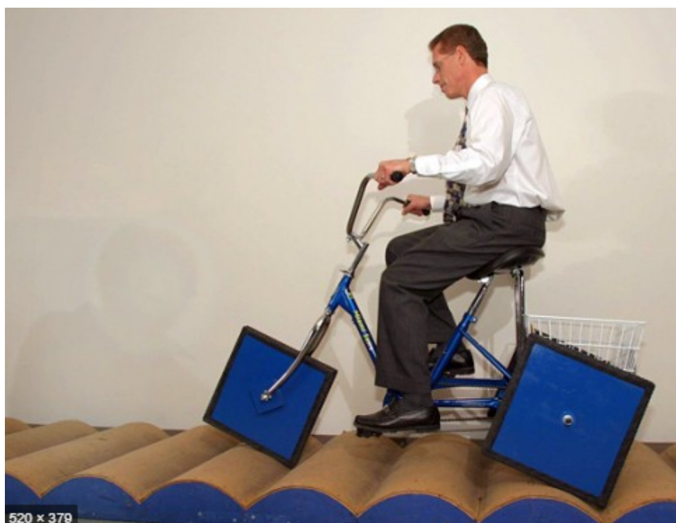
Figura 1 Veículo de rodas quadradas
