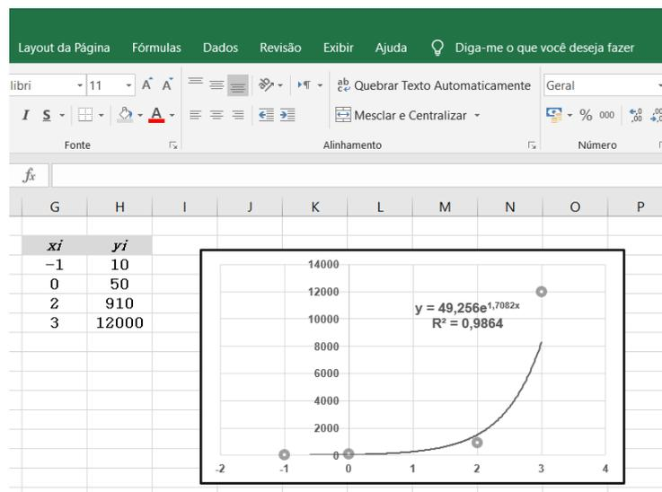
Figura 36: Manual de EXCEL para ajuste de curva — Passo 8
