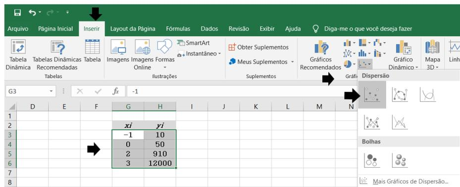
**Figura 32: Manual de EXCEL para ajuste de curva — Passo 4**
