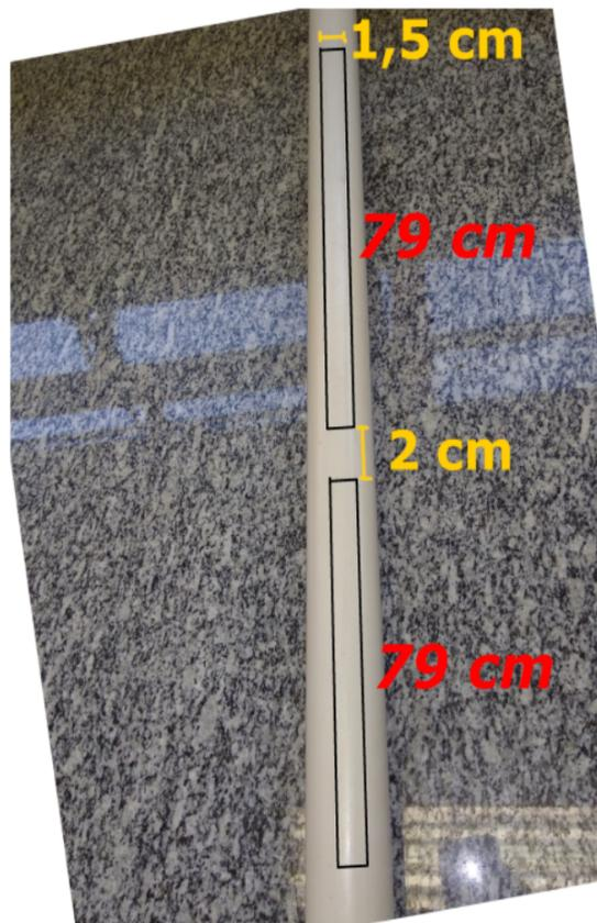
**Figura 49: Cortes na construção do Tubo de Teste**
