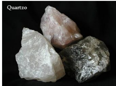
Figura 10 – Mineral Quartzo sujeito a uma pancada partindo-se de forma irregular (Fractura).
