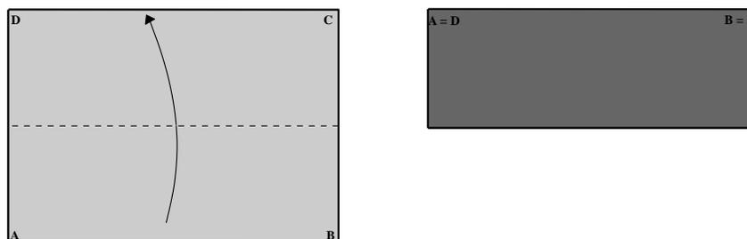
**Passo 2:** Desdobre. Faça uma dobra que passe pelo vértice  $D$  e de modo que o vértice  $A$  fique sobre a dobra obtida no passo 1. Seja  $E$  o ponto que  $A$  determina em tal dobra. Note que, ao se fazer esta dobra, obtém o segmento  $DE$  que é congruente ao segmento  $AD$ .
