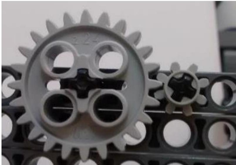
Figura 33 – Acoplamento de duas engrenagens diferentes
