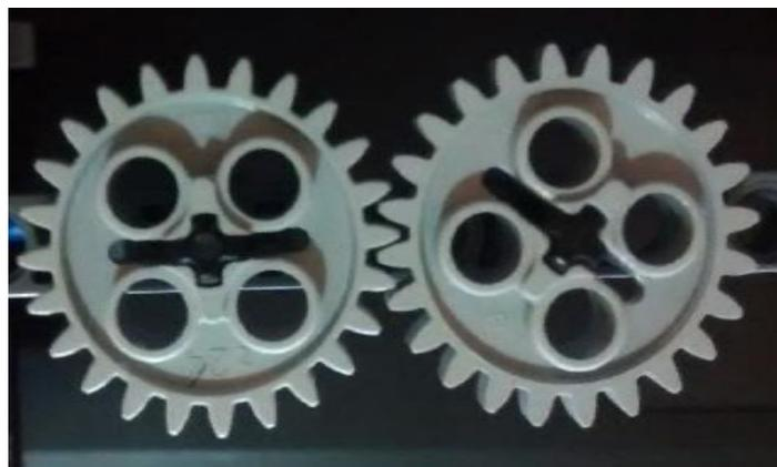
Figura 32 – Acoplamento de duas engrenagens idênticas
