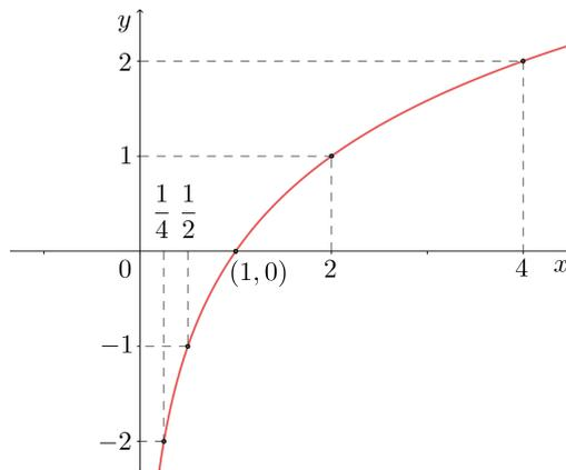
Figura 27 – Gráfico da função logarítmica  $y = \log_2 x$
