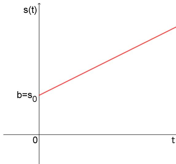
Figura 37 – Gráfico de  $s \times t$  no Movimento Uniforme.
