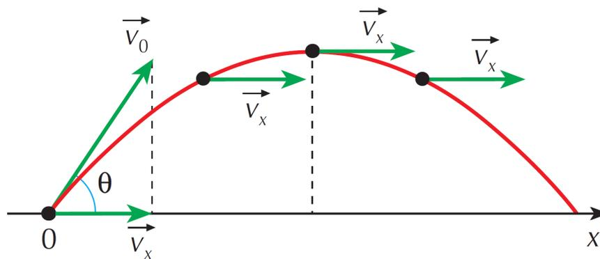
Figura 48 – A velocidade horizontal  $v_x$  constante durante o movimento oblíquo.
