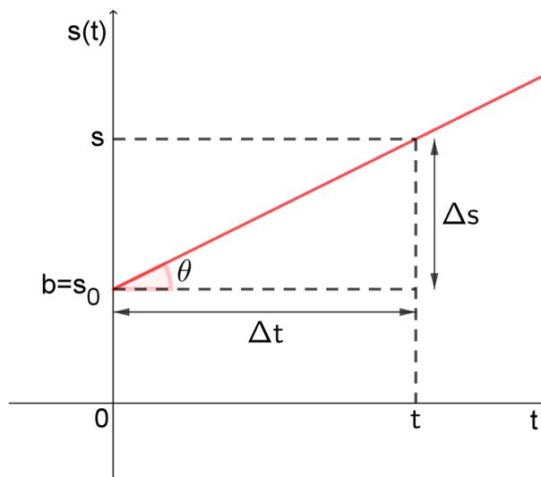
Figura 38 – A velocidade escalar como declividade da reta de  $s \times t$  no Movimento Uniforme
