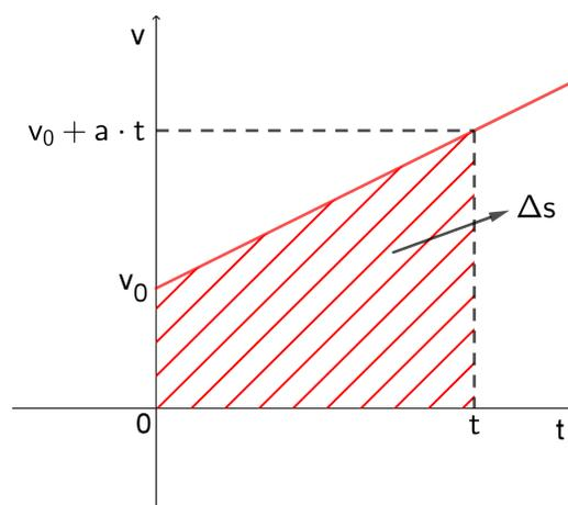
Figura 46 – A variação do espaço percorrido  $\Delta s$  como área sob a curva do gráfico de  $v \times t$  de 0 a  $t$ .
