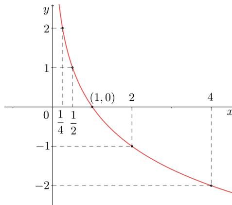
Figura 28 – Gráfico da função logarítmica  $y = \log_{\frac{1}{2}} x$
