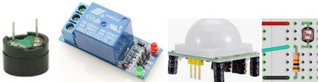
Figura 13 – Buzzer, relé, sensor de presença e ldr
