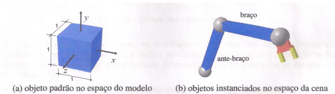
Figura 2.11: Instanciação de objetos num braço mecânico simples
