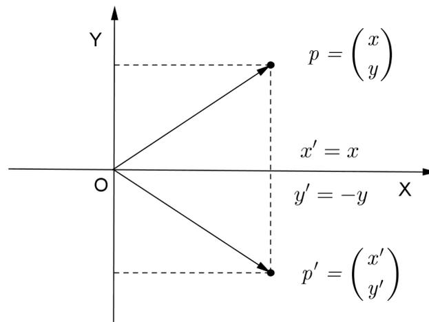
Figura 1.7: Transformação de espelhamento em relação ao eixo  $x$
