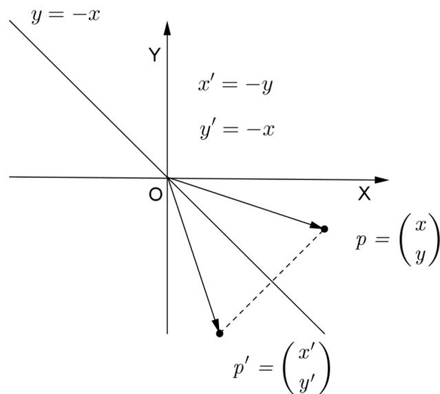
Figura 1.10: Transformação de espelhamento em torno da reta  $y = -x$
