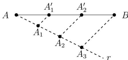
Figura 3.24: Segmento dividido em 3 partes iguais.
