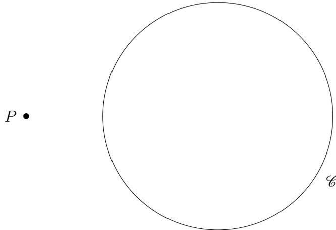
Figura 3.28: Circunferência  $\mathcal{C}$  e ponto  $P$  para determinação das tangentes.
