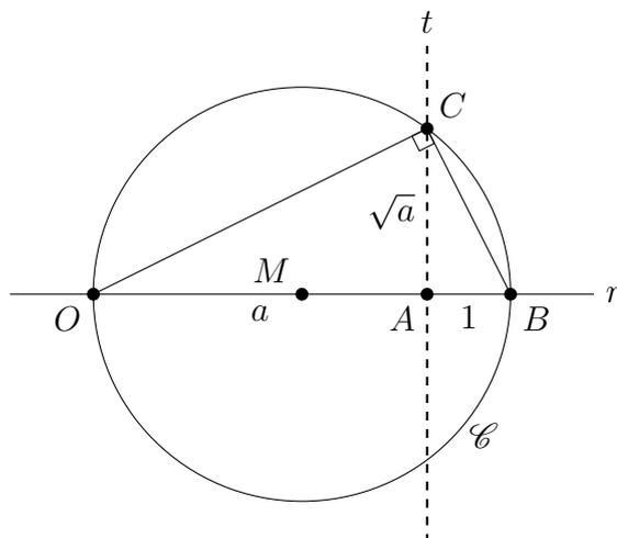
Figura 3.49: Segmento  $\sqrt{a}$  como altura de um triângulo retângulo.
