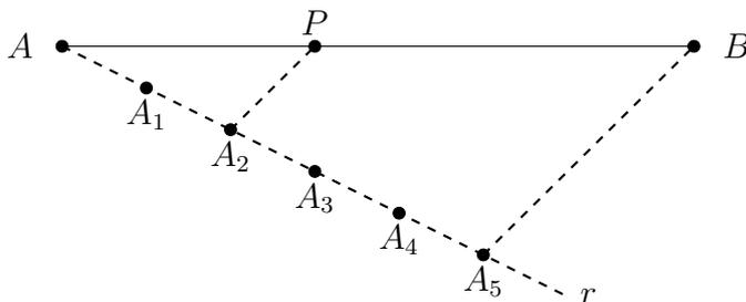
Figura 3.25: Divisão de um segmento  $\overline{AB}$  proporcional a 2 e 3.
