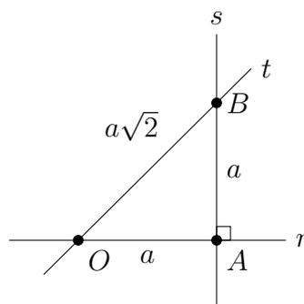
Figura 3.34: Construção do segmento  $a\sqrt{2}$ .
