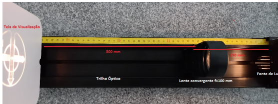
Figura 5.3: Foto da disposição dos elementos ópticos fixados conforme as distâncias calculadas com auxílio dos métodos I e II. Fonte: O Autor
