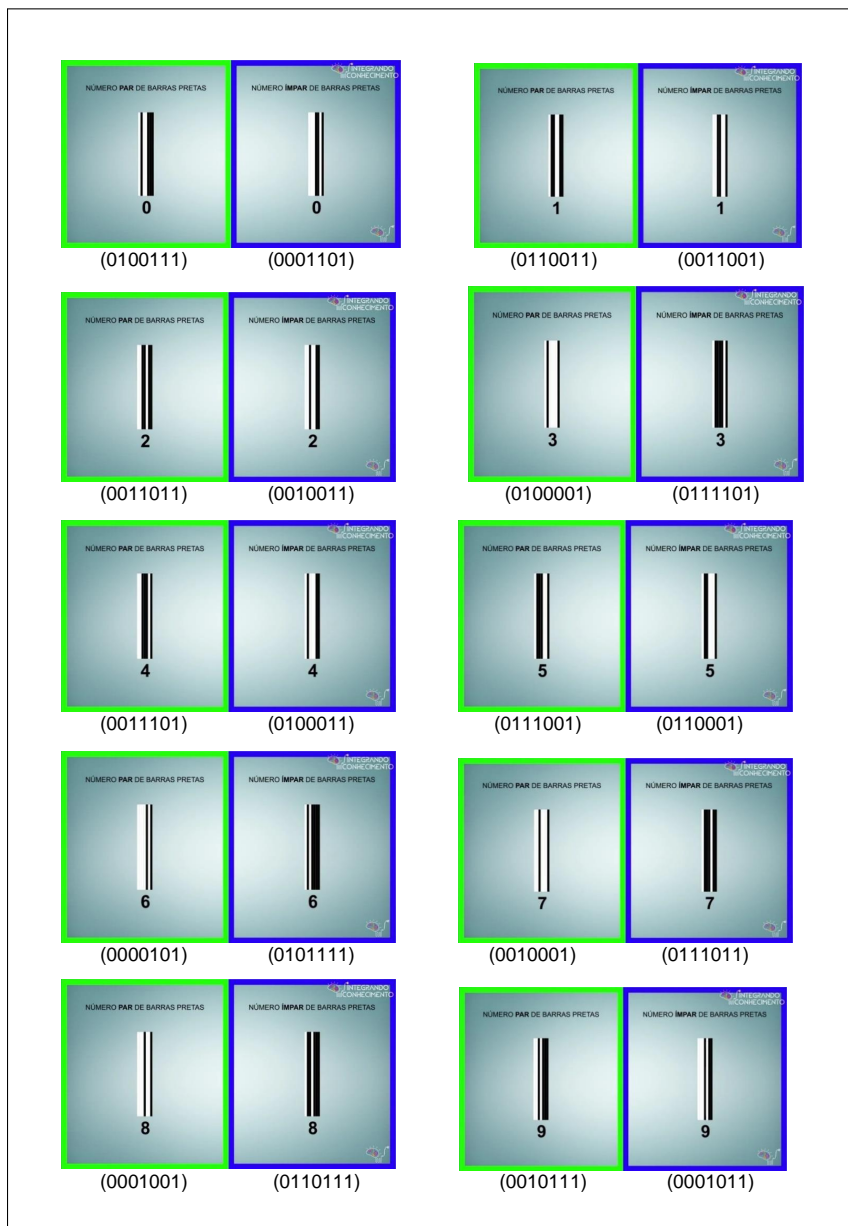
Figura 15 – Codificação do lado esquerdo dos Códigos de barras com suas respectivas barras e paridade
