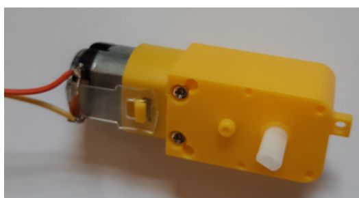
Figura 75 – Motor CC de 3-6 V com caixa de redução de 1:48 e eixo duplo.
