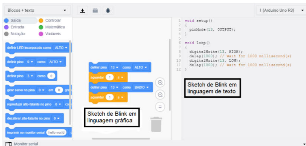
Figura 71 – Programação em linguagem gráfica do código de Blink elaborado no Tinkercad da Autodesk.
