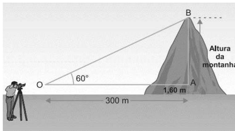
Posiciona o aparelho que lhe fornece a medida do ângulo de visada de parte do morro, igual a  $60^\circ$ . Sabendo que o teodolito tem altura de 1,60 m, o topógrafo pode determinar a altura da montanha. Qual é essa altura? Adotando ( $\sqrt{3} = 1,732$ )
