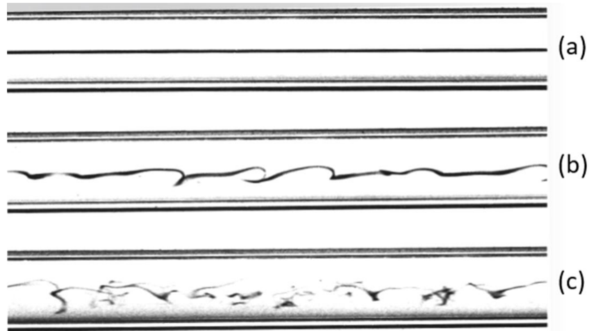
Figura 5: Transição de escoamento laminar e para turbulento. (Fonte: ESSS)
