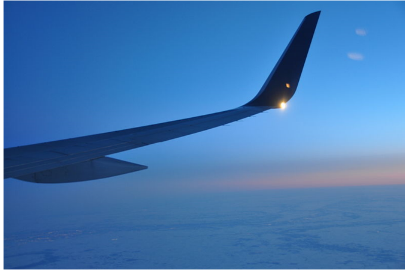
Figura 1: Dispositivo de ponta de asa do tipo winglet . (Fonte: Creative Commons )
