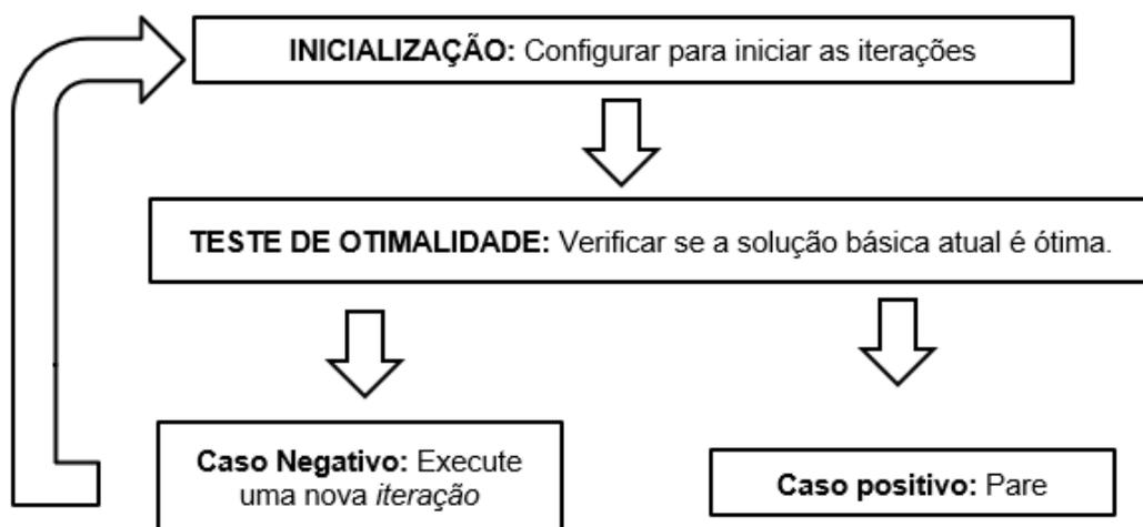
Figura 9: Estrutura do Método Simplex
