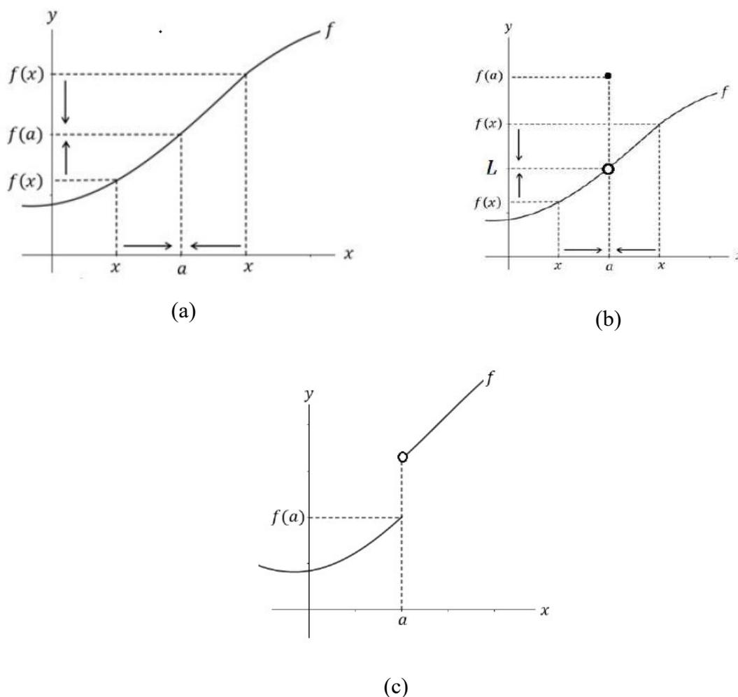
Figura 1: (a) exemplo de função contínua em  $a$ ; (b) e (c) exemplos de funções não contínuas em  $a$
