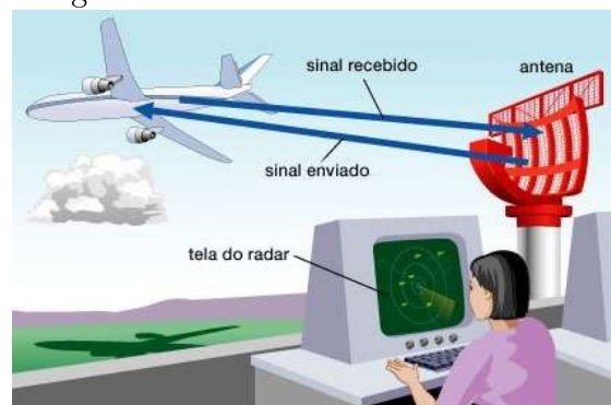
Figura 5.56: Funcionamento do radar
