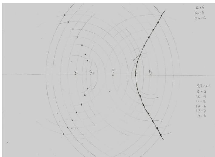
Figura 6 Hipérbole traçada com régua graduada e compasso
