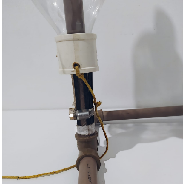
Figura 2.20: Encaixe do gatilho de liberação para o lançamento
