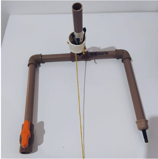
Figura 2.16: Passo 9 da montagem da base do foguete
