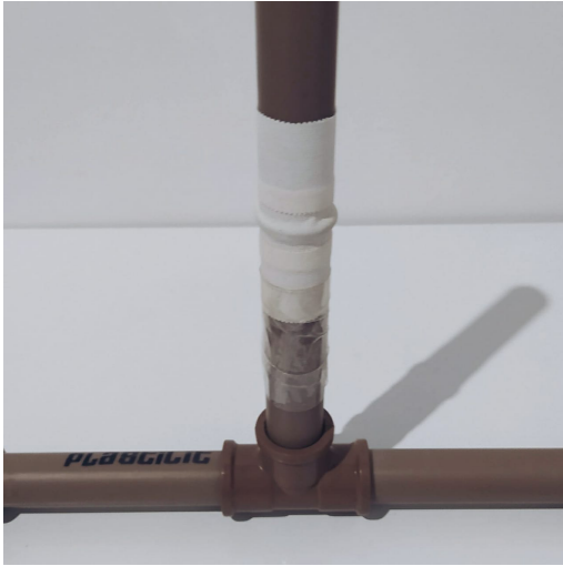
Figura 2.12: Passo 5 da montagem da base do foguete
