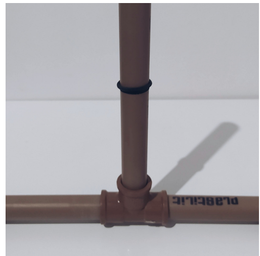
Figura 2.11: Passo 4 da montagem da base do foguete
