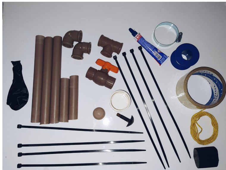
Figura 2.7: Materiais necessários para a construção da base foguete
