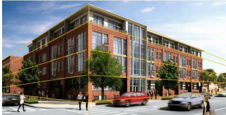
Figura 7 - Perspectiva com dois pontos de fuga
