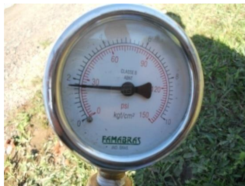
Figura 3.18 – Manômetro no nível do solo, próximo ao reservatório, marcando a pressão, em \text{kgf/cm}^2 , respectiva ao nível 7.
