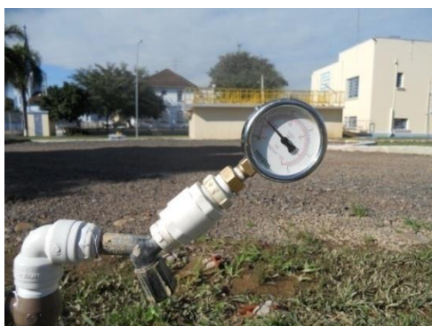
Figura 3.18 – Manômetro no nível do solo, próximo ao reservatório, marcando a pressão, em \text{kgf/cm}^2 , respectiva ao nível 7.
