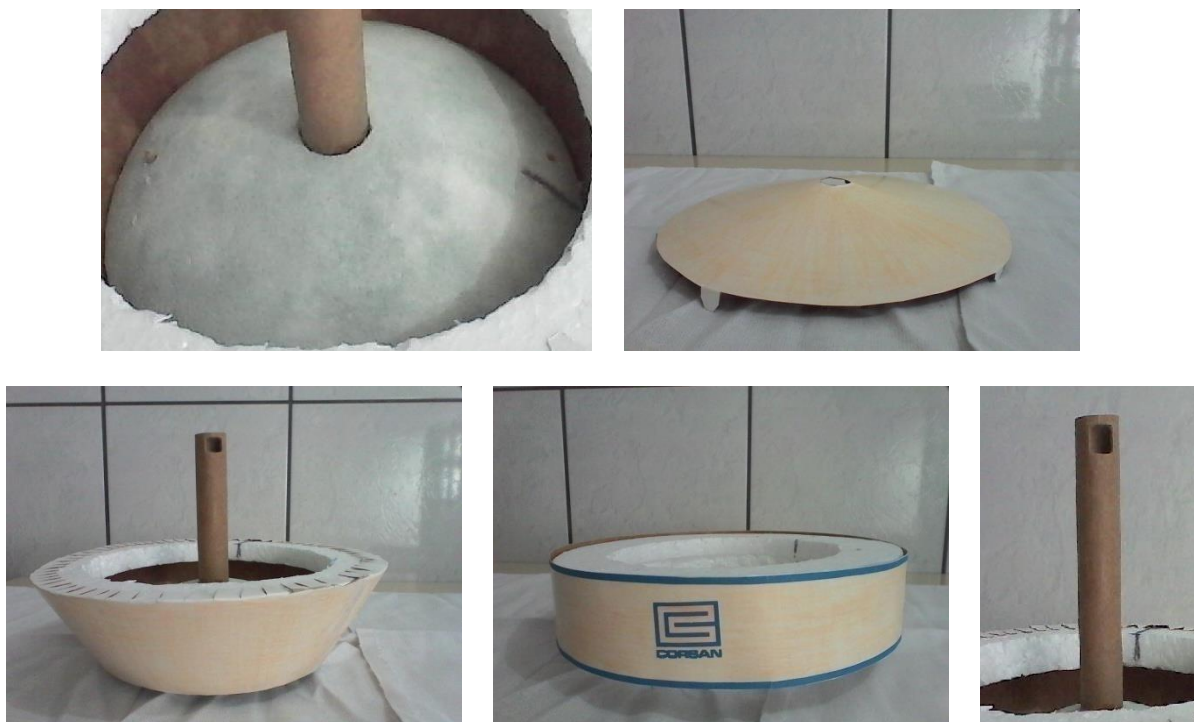
Figura 3.14 – Partes da Maquete do reservatório. Da esquerda para a direita: em cima: calota inferior ; calota superior . Embaixo: cilindro do reservatório , tronco do cone , poço de visita .
