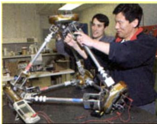
Figura 82 – Os engenheiros Caner Copperrider e Ken Lee trabalham no protótipo do robô tetwalker no Goddard Flight Center da NASA.
