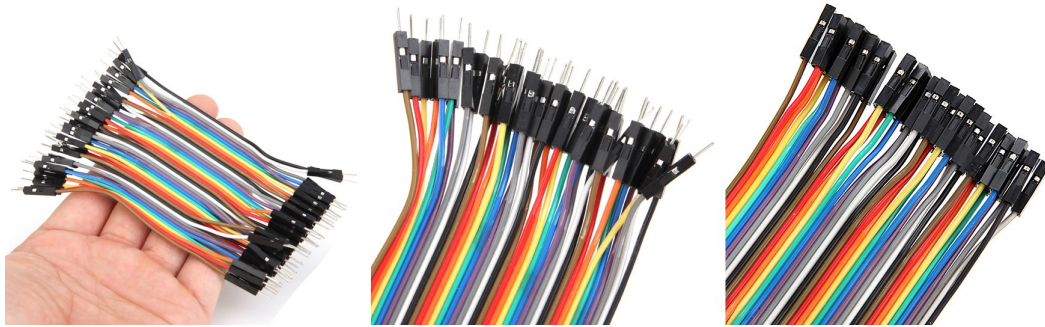
Figura 8 – Cabos conectores ( jumpers ) para conexão na proto board.
