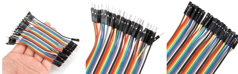
Figura 2.5: Cabos conectores ( jumper ) para conexão na protoboard .
