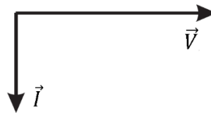
Figura 23 - Diagrama fasorial para um elemento indutivo.
