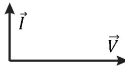
Figura 27 - Diagrama fasorial para um elemento capacitivo.
