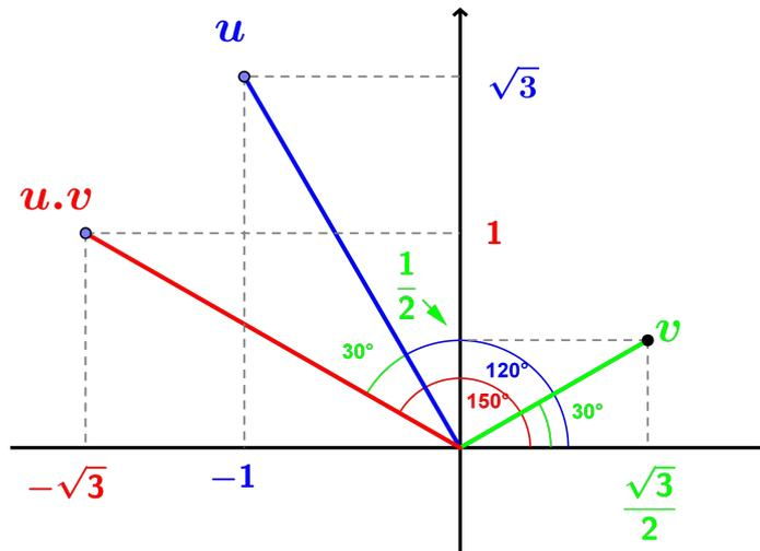
Figura 3.2: Rotação de  $30^\circ$  em torno da origem.
