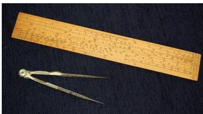
Figura 08 - Régua de Günter e compasso
