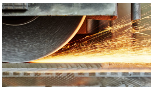
Figura 4.18: Processo de retificação
