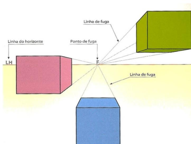
Figura 37 – Representação da perspectiva cônica de um cubo com um ponto de fuga
