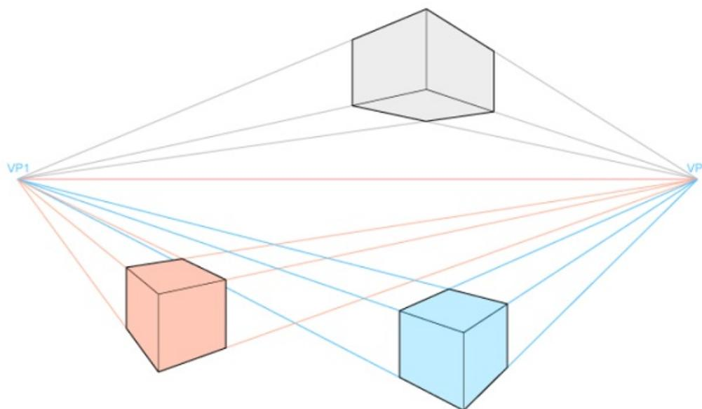
Figura 40 – Representação de um cubo em perspectiva cônica com dois pontos de fuga
