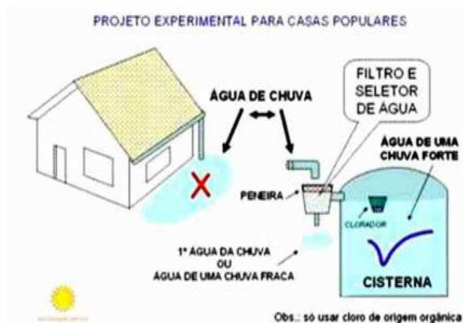
Figura 9 - Sistema de Cisterna
