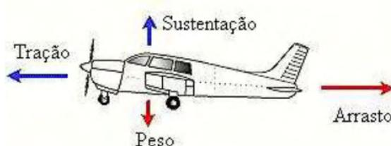
Figura 6: Forças que atuam em um avião, figura retirada de [8]
