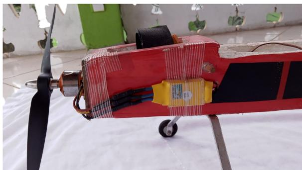
Figura 11: Foto do esc na fuselagem.
