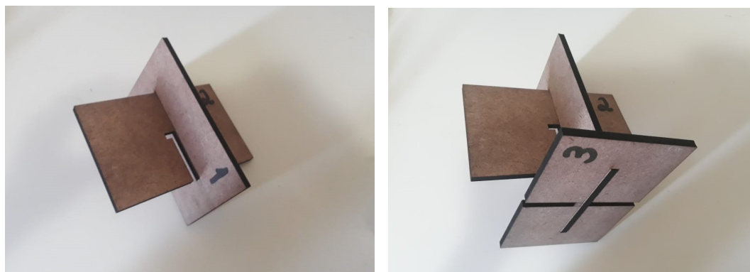
(a) Primeiro passo: encaixe a Placa 1 com a Placa 2 dessa maneira (b) Segundo passo: encaixe a Placa 3 na Placa 1
