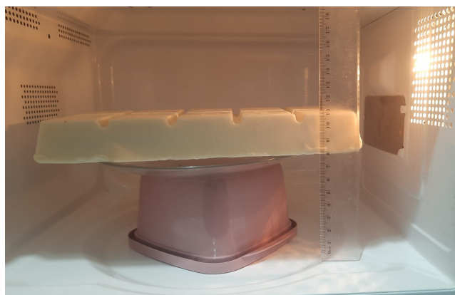
Figura 5.5 – Barra de chocolate acomodada a 8cm da base do micro-ondas
