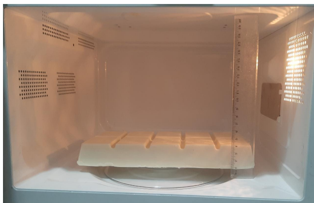
Figura 5.4 – Barra de chocolate acomodada a 1cm da base do micro-ondas
