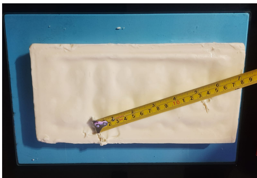
Figura 5.6 – Barra de chocolate a 1 cm da base e a distância entre os pontos derretidos
