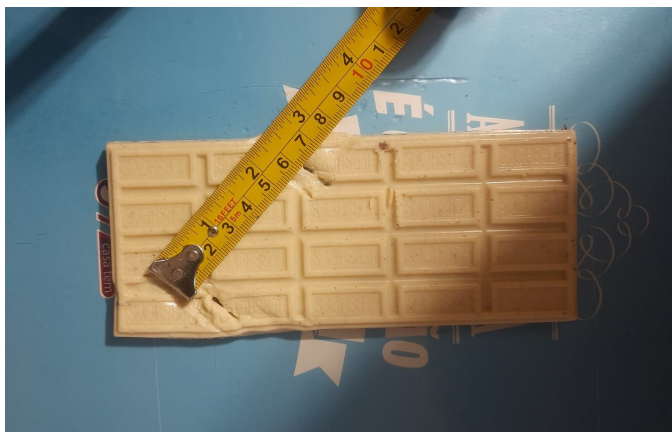
Figura 5.13 – Distância entre os pontos de derretimento na posição horizontal
