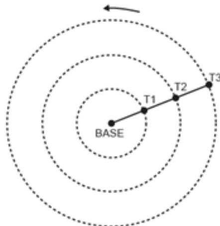
Um pivô de três torres ( $T_1$ ,  $T_2$  e  $T_3$ ) será instalado em uma fazenda, sendo que as distâncias entre torres consecutivas bem como da base à torre  $T_1$  são iguais a 50 m. O fazendeiro pretende ajustar as velocidades das torres, de tal forma que o pivô efetue uma volta completa em 25 horas.
