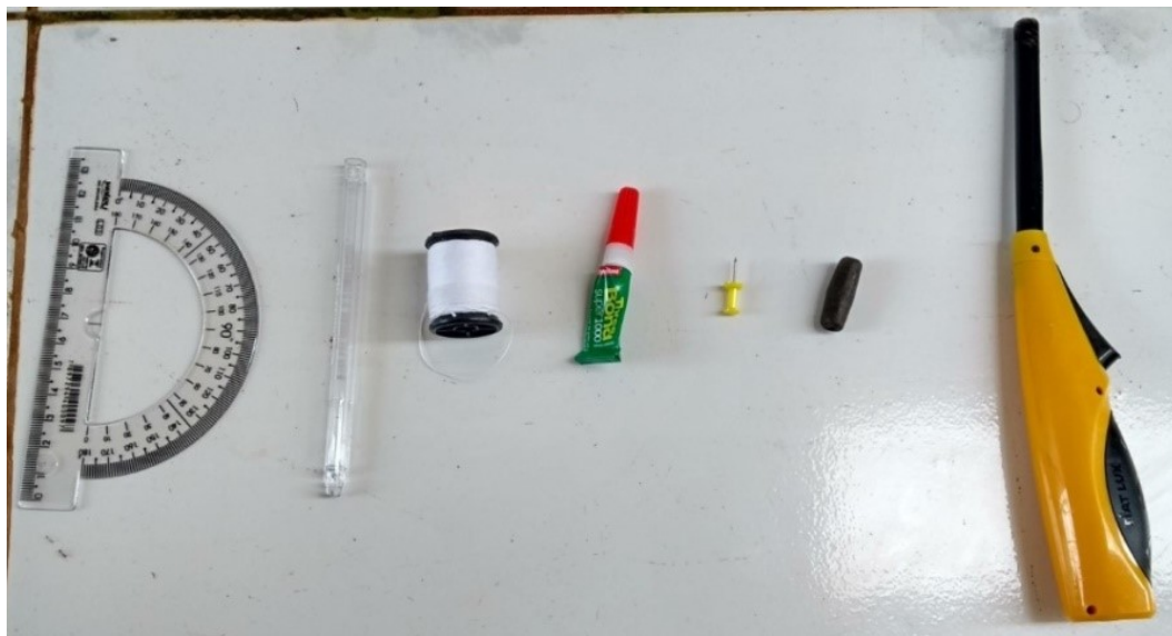
Figura 3.15 – Materiais para confecção do astrolábio caseiro
