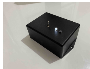
Figura 3.28: Bloco de negação montado.
