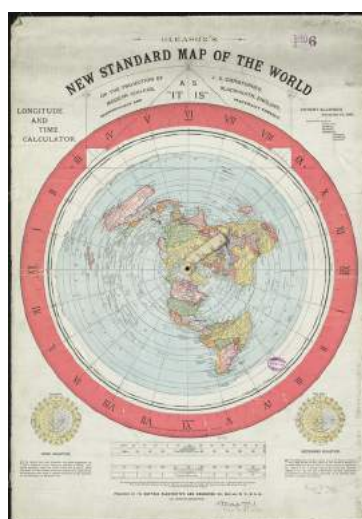
Figura 31 – Projeção azimutal equidistante apresentada por Alexander Gleason em 1892.
