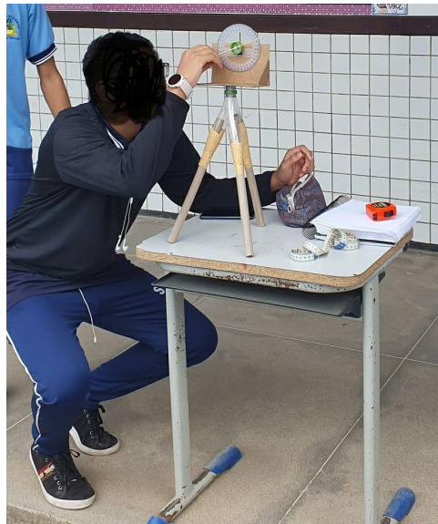
Figura 12: Integrante do grupo utilizando o teodolito para estimar ângulos
