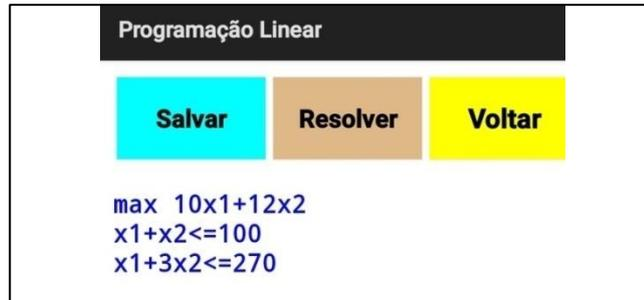
Figura 5.14. Modelo do problema digitado no software.
