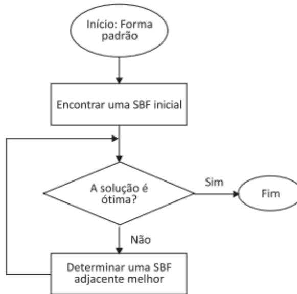
**Figura 3.2.1:** Fluxograma da descrição geral do algoritmo Simplex
