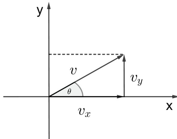
Figura 1.7: Componentes de um vetor.
