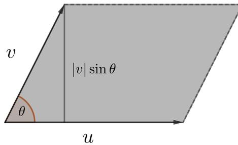
Figura 1.10: Interpretação geométrica do módulo do produto vetorial de dois vetores.
