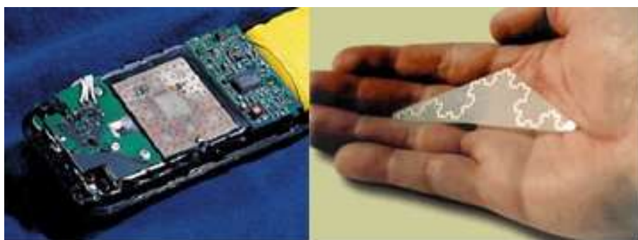
Figura 3.14: Celular da motorola e a primeira antena fractal. [1]
