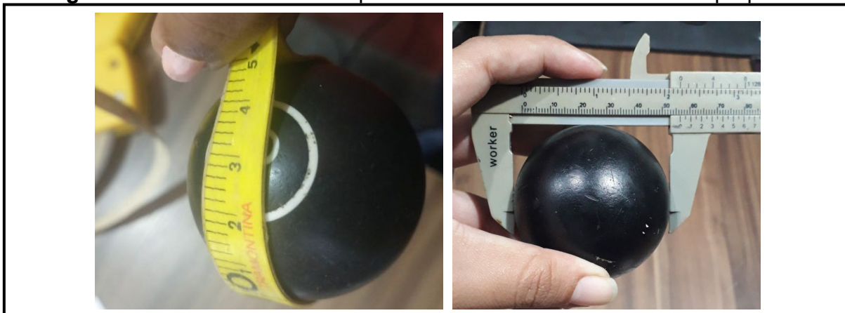
Imagem 13 – Medindo a bolinha preta com o uso de uma trena e do paquímetro
