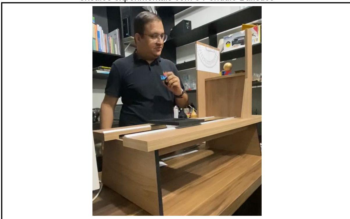
Imagem 11 - Professor pesquisador fazendo os ensaios experimentais com o Pêndulo Balístico
