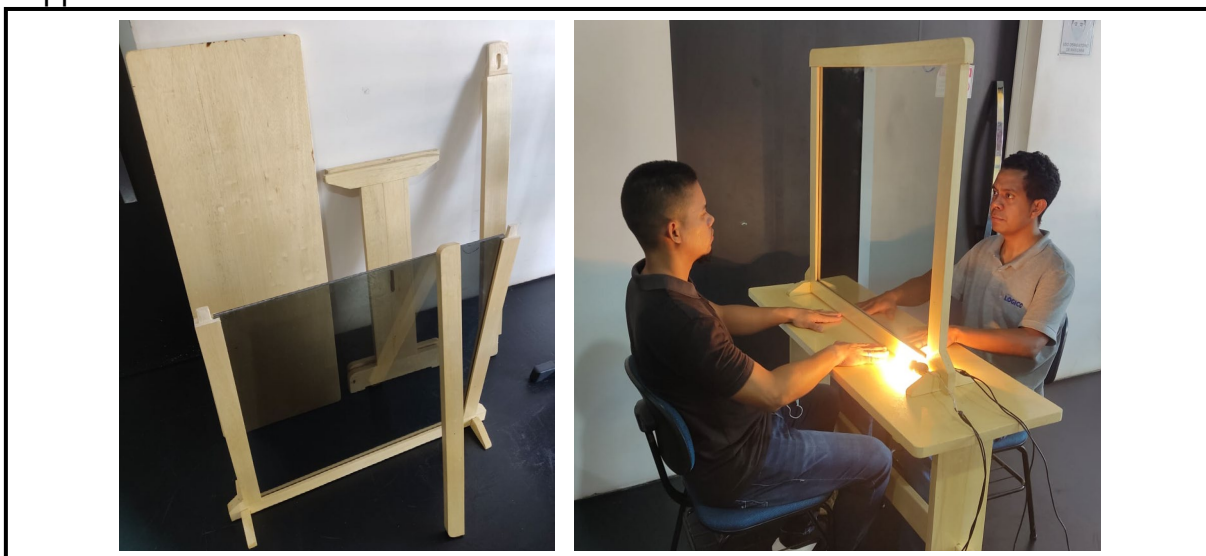
Imagem 03 - As peças para Montagem e o Aparato Experimental Fantasma de Pepper em uso
