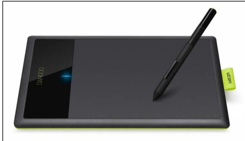
*Figura 1 - Mesa digitalizadora Wacom Bamboo Connect*
