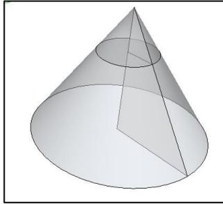
Figura 51 - Cone e secção esboçados com auxílio da ferramenta “siga-me”
