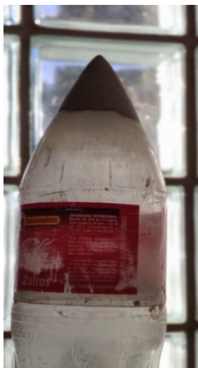
Figura 70 – Aparato maciço feito com cola Epóxi para exercer a força peso
