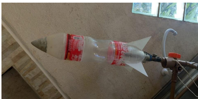
Figura 71 – Aletas e ponteira refeita para os novos testes
