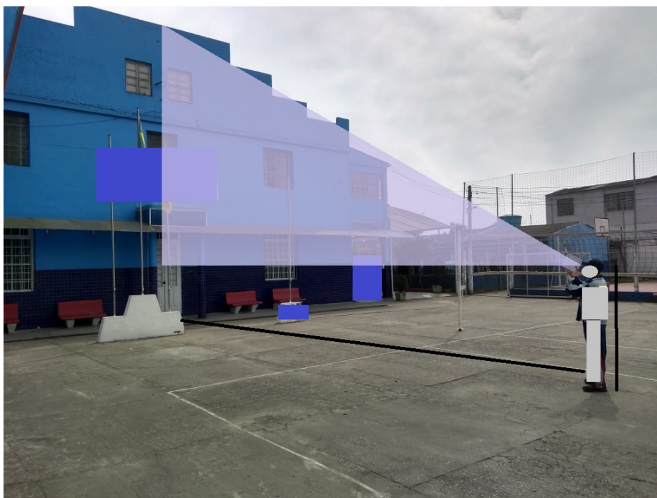
Figura 34 – Situação para uso dos teodolitos para medir a altura do prédio da escola
