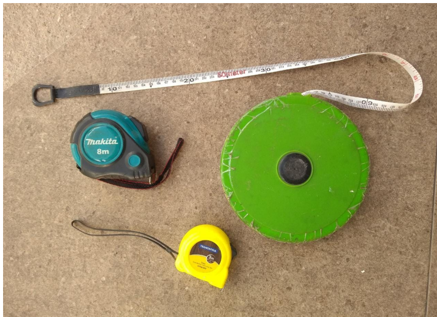
Figura 30 – Trensas usadas para medir alturas e distâncias
