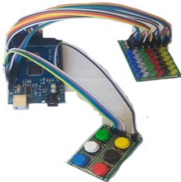
Figura 18 - Estrutura completa do Jogo da Senha em Arduino
