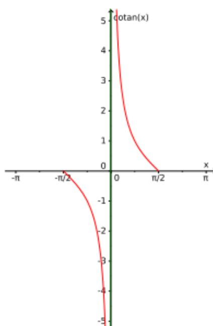
Figura 3.12: Gráfico da função cotangente em  $(-\pi/2, 0) \cup (0, \pi/2)$
