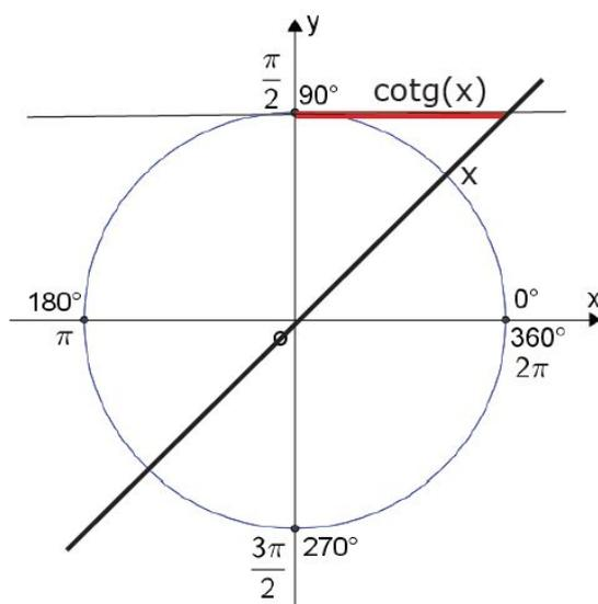
Figura 2.17: Cotangente no ciclo trigonométrico
