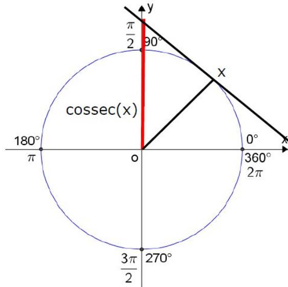
Figura 2.11: Cossecante no ciclo trigonométrico
